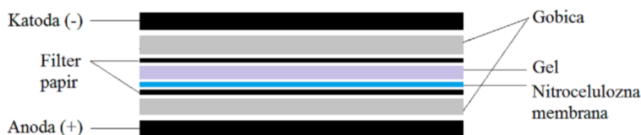
Slika 11: Sestava aparature za prenos western.
