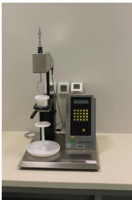
SLIKA 15: NAPRAVA ZA DOLOČANJE PRETOČNOSTI. POLEG MERITEV PRETOČNOSTI SMO JO UPORABILI ZA FORMIRANJE KUPA, S POMOČJO KATEREGA SMO DOLOČALI POTENCIALNO SEGREGACIJO V ZMESI.
