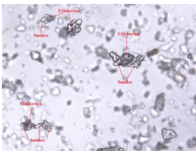
Slika 16: Pregled delcev in agregatov v zmesi 001X-M (200x povečava)
