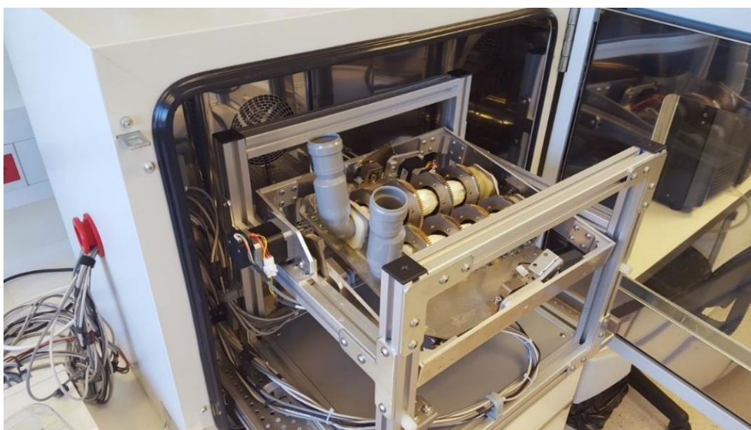
Slika 6: Fotografija naprave za posnemanje gibanja tankega črevesa
