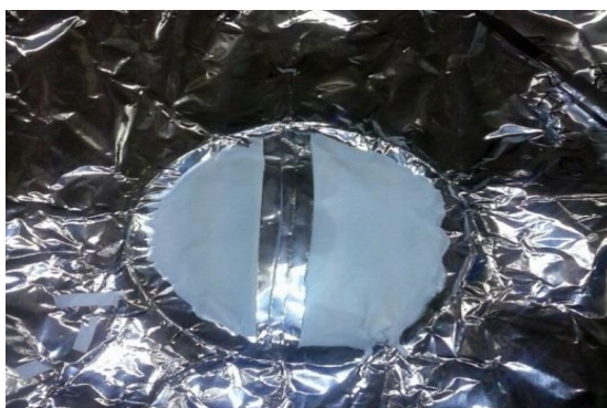
Slika 5: Vzorec filma, ki smo ga pripravili iz suspenzije karvedilola v polimerni raztopini, na aluminijasti foliji.
