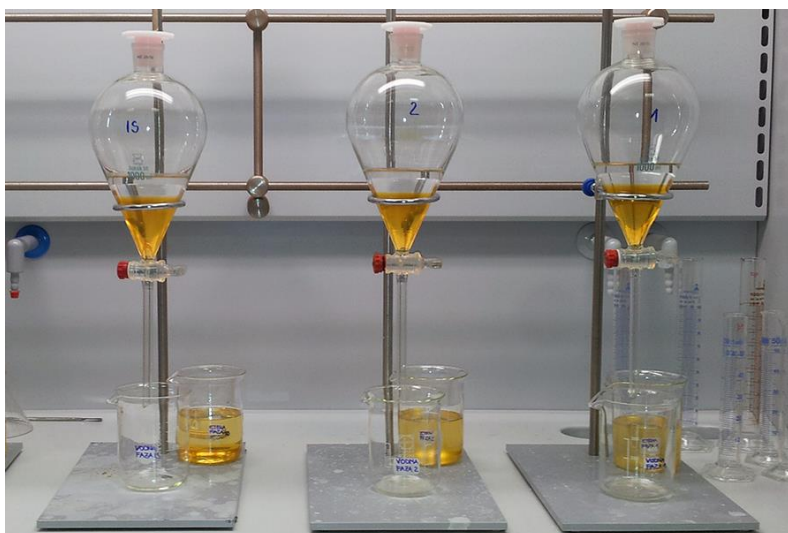
Slika 12: Ekstrakcija neumiljivih snovi z dietil etrom [osebni arhiv].
