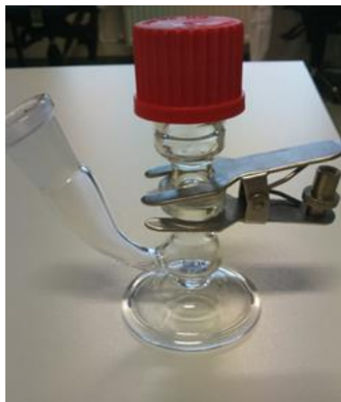
Slika 8: Franzova celica uporabljena v eksperimentu
