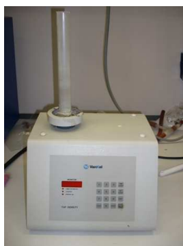
Slika 3. Naprava za določanje zbitega volumna (Vir: Univerza v Ljubljani, Fakulteta za farmacijo).
