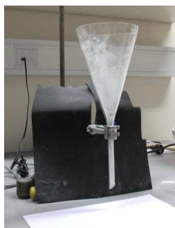
Slika 2. Lij za merjenje pretočnega časa in nasipnega kota (Vir: Univerza v Ljubljani, Fakulteta za farmacijo).
