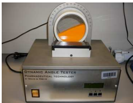
Slika 4. Prikaz vrtečega bobna in merjenja nasipnega kota (Vir: Univerza v Ljubljani, Fakulteta za farmacijo).
