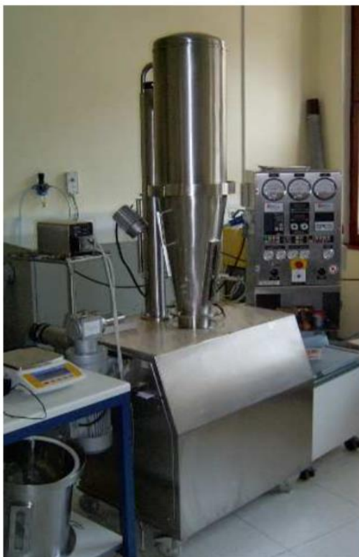
Slika 7: Granulator GPCG1 na katedri za farmacevtsko tehnologijo.
