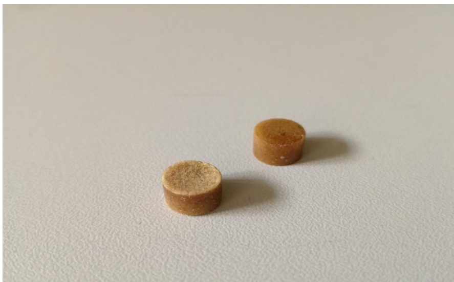
Slika 30: Zgodnja stran tablete z konkavno površino (levo) in spodnja stran tablete (desno).
