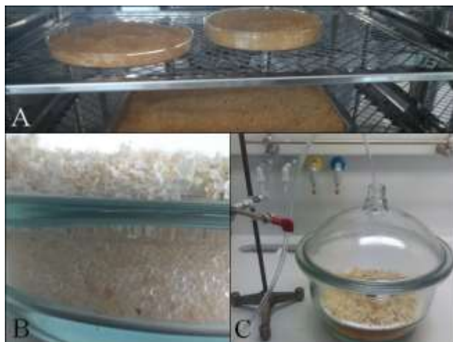
Slika 10: A: Sušenje kroglic silikagela v peči; B in C: sušenje cvetov črnega bezga v eksikatorju v argonovi atmosferi (foto: M. Sikošek).
