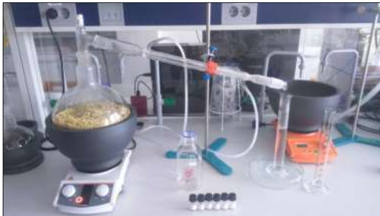
Slika 14: Klasična destilacija – zbiranje frakcij hidrolata (foto: M. Sikošek).
