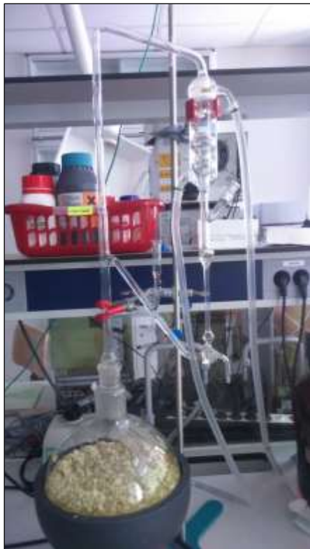
Slika 11: Destilacija cvetov črnega bezga s Clevengerjevo aparaturo (foto: M. Sikošek).
