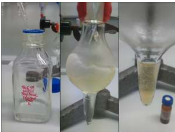
Slika 16: Koncentriranje ekstrakta s prepihanjem z argonom (foto: M. Sikošek).
