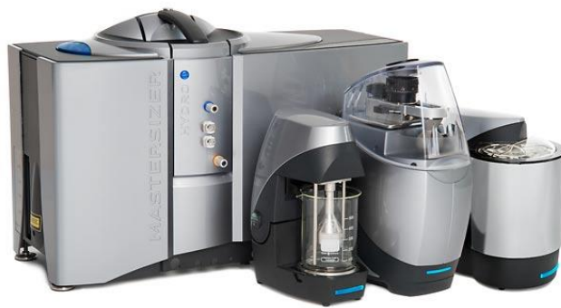
Slika 13: Mastersizer 3000 - merilna naprava v ozadju, disperzni moduli (mokra, suha, mokra) v ospredju (28)
