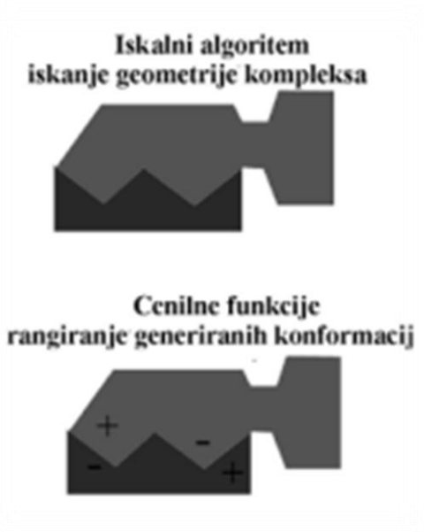
Slika 13: Shematski prikaz metode molekulskega sidranja. Za izbrano tridimenzionalno strukturo tarče iskalni algoritem izračuna možne orientacije (vezavne geometrije) liganda v aktivnem mestu. Cenilna funkcija nastali vezavni geometriji liganda izračuna pripadajočo energijo afinitete, ki predstavlja oceno intenzitete interakcij z makromolekulo . Povzeto po (35).
