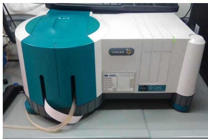
Slika 10: UV – Vis spektrofotometer Cary 50 Conc, proizvajalca Varian.
