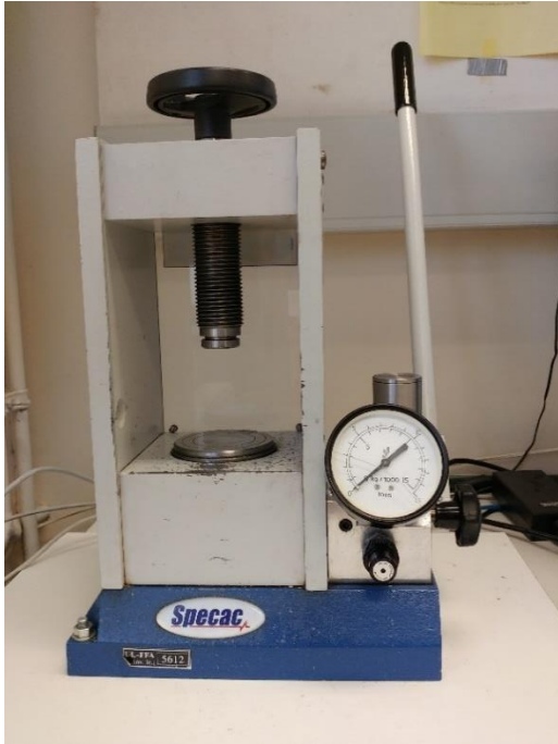
Slika 13: Hidravlična stiskalnica (levo) in kovinska matrica s pečatom ter spodnjim nastavkom (desno).
