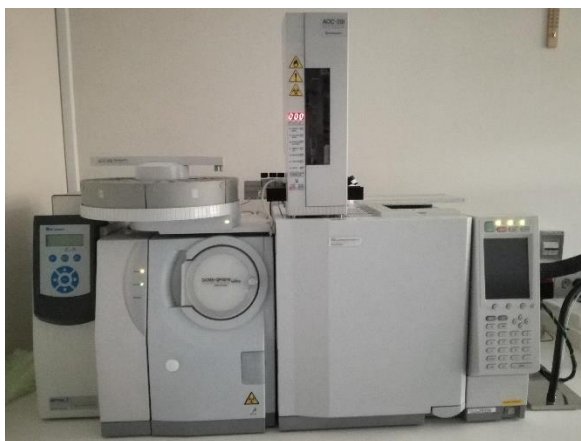
Slika 6: Sistem GC-MS s Katedre za farmacevtsko biologijo na Fakulteti za farmacijo.
