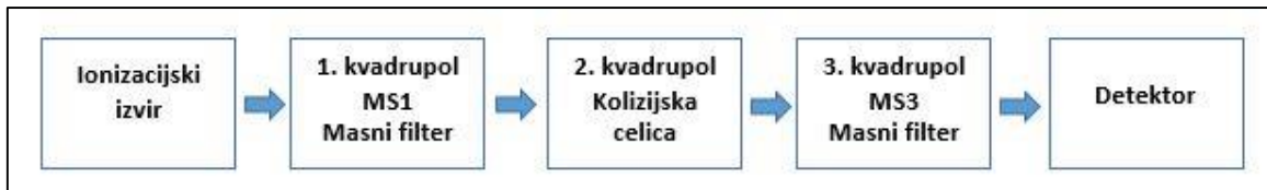
Slika 5: Shematski prikaz QQQ analizatorja, povzeto po (32)
