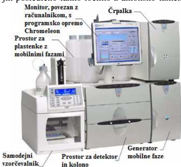
Slika 4: Ionski kromatografski sistem za izvajanje HPAEC-PAD (povzeto po 53)
