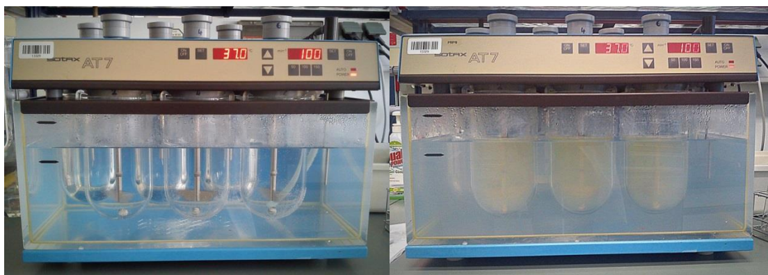
Slika 8: Naprava z vesli (USP aparat 2) med testom sproščanja. Na levi poteka sproščanje v mediju brez pektina, na desni pa v mediju, ki smo mu dodali pektin. Vir: Helena Vrbanac
