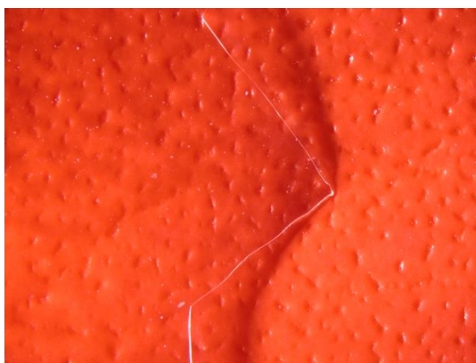
Slika 32: Film iz HPMCP-ja 55, mehčalo je 10 % TEC.
