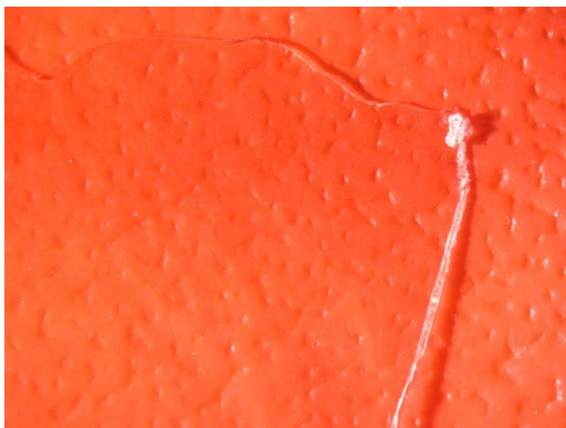
Slika 9: Gladek in transparenten film (etanolna raztopina HPMC AS-a in 15 % TEC-a).
