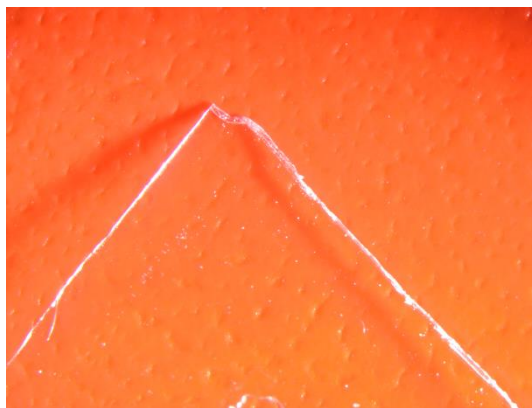
Slika 41: Film iz HPMCP-ja 55 proizvajalca Samsung in 10 % PEG-a.
