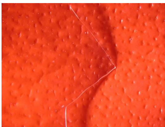
Slika 4: Upognjen film iz HPMCP-ja 55 Harke z 10 % TEC-om.
