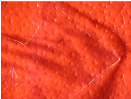
Slika 36: Prosojen in čvrst film iz CAP-a z 20 % TEC-em kot mehčalom.
