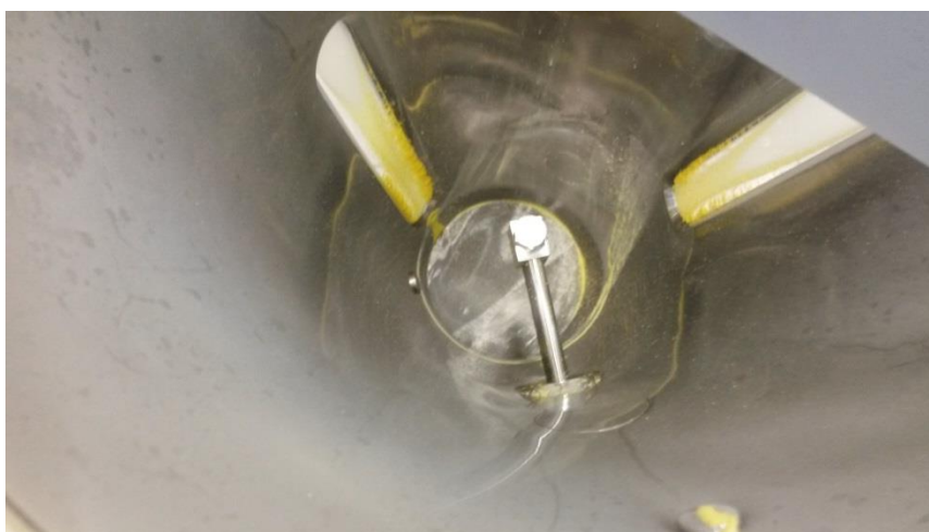
Slika 16: Prazna komora po izsutju produkta izdelanega pri spodnjem položaju šobe.
