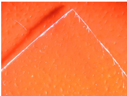
Slika 40: Film iz HPMCP-ja 55 proizvajalca Samsung in 10 % TEC-a.
