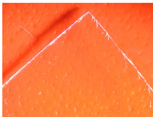
Slika 5: Čvrst in ploščat film iz HPMCP-ja 55 Samsung in 10 % TEC-a.
