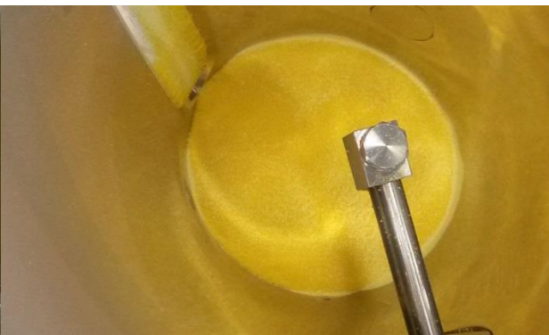
Slika 15: Zanemarljivo lepljenje delcev na steno komore pri spodnjem položaju šobe.
