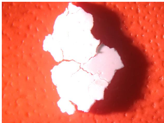
Slika 7: Rahlo povezani beli koščki polimera (vodna suspenzija HPMC AS-a in 20 % PEG-a).
