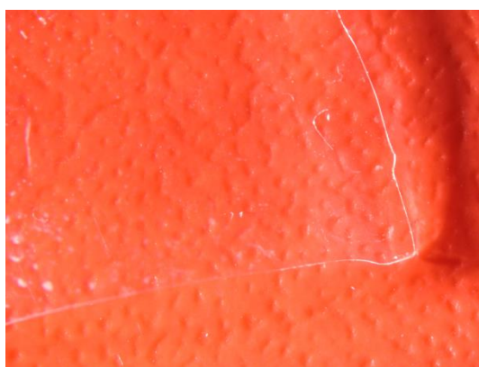
Slika 38: Homogen in prosojen film, brez zračnih mehurčkov, izdelan iz HPMCP-ja 55s in 10 % TEC-em.
