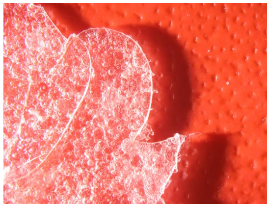
Slika 8: Deloma transparenten in čvrst film (vodna suspenzija HPMC AS-a in 20 % TEC-a).
