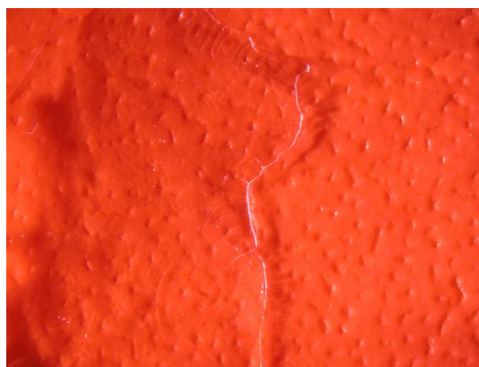
Slika 33: Film iz HPMCP-ja 55, mehčalo je 10 % PEG.
