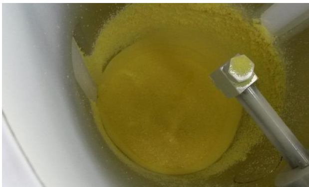
Slika 14: Veliko prilepljenih delcev na steno komore kot posledica zgornjega položaja šobe.
