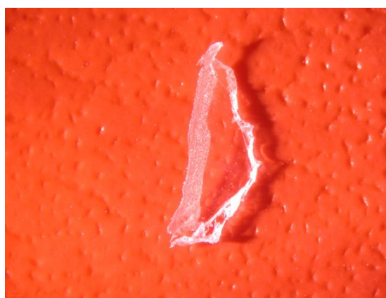
Slika 6: Prosojen in homogen film brez zračnih mehurčkov iz Eudragita ® z 20 % TEC-om.
