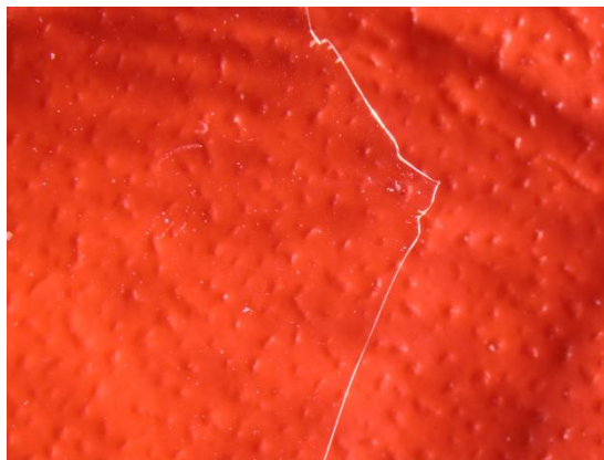
Slika 37: Prosojen in čvrst film iz CAP-a z 20 % PEG-om kot mehčalom.
