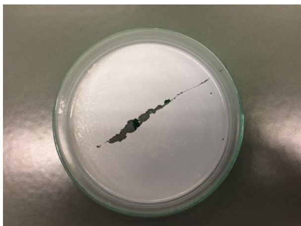
Slika 11: Film izdelan iz vodne suspenzije Sureteric® brez dodatnih mehčal.
