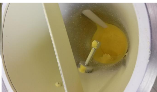
Slika 20: Velika količina z razprševanjem posušenih delcev, ki se odložijo na stene komore pri filterih, ob uporabi manjšega deleža vode v raztopini za oblaganje.
