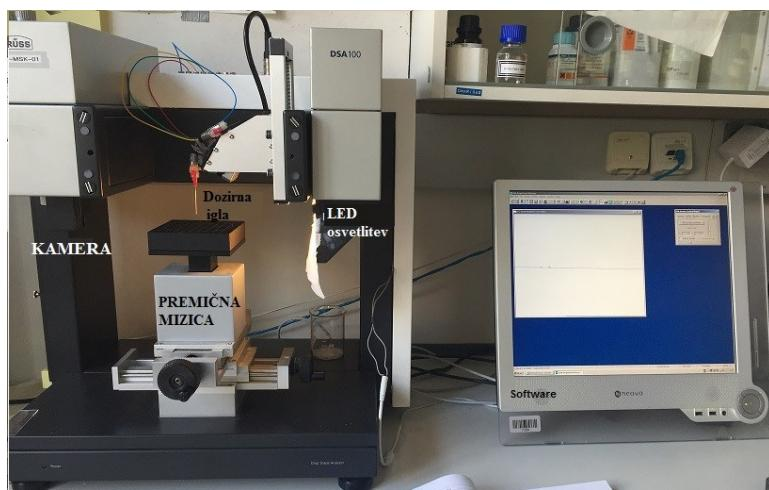
Slika 9: Naprava za merjenje stičnega kota, Drop Shape Analysis System DSA 100 Contact Angle Meter KRUSS.
