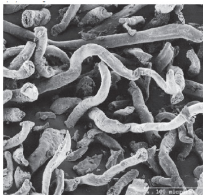
Slika 11: SEM slika razgrajevala Ac-Di-Sol ® proizvajalca FMC Biopolymer (1000x povečava) (24).
