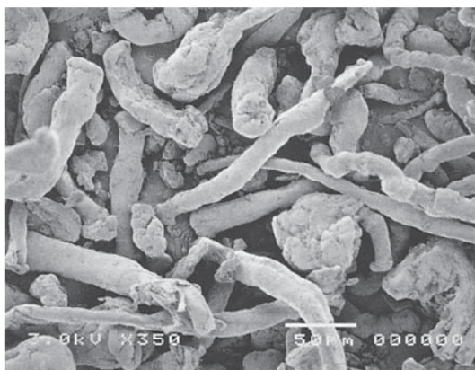
Slika 15: SEM slika delcev L-HPC® LH-21 proizvajalca Shin-Etsu Chemical Co. Ltd., na kateri je vidna vlaknasta struktura delcev (350x povečava) (24).
