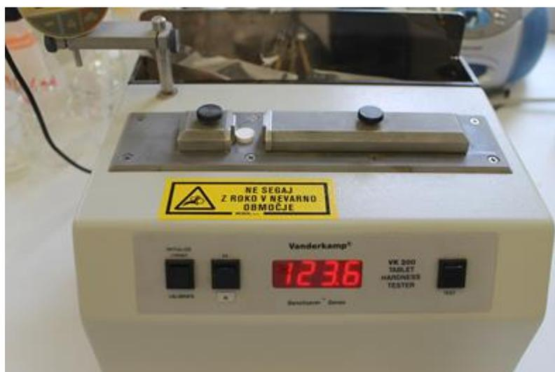
**Slika 16: Naprava za določanje trdnosti tablet, Tablet hardness tester VK 200, Vanderkamp, ZDA.**
