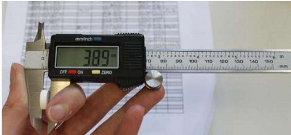
**Slika 15: Precizno digitalno kljunasto merilo PMS 150 M 823-160.**
