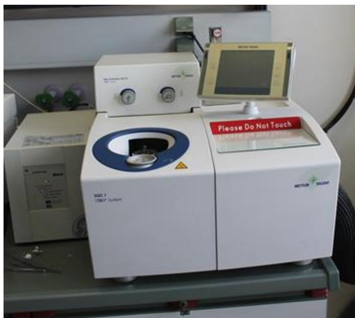
Slika 9: Diferenčni dinamični kalorimeter DSC 1 Star®, Mettler Toledo, Švica.
