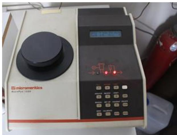
**Slika 13: Helijev piknometrom AccuPyc 1330 Pycnometer, Micromeritics, ZDA.**
