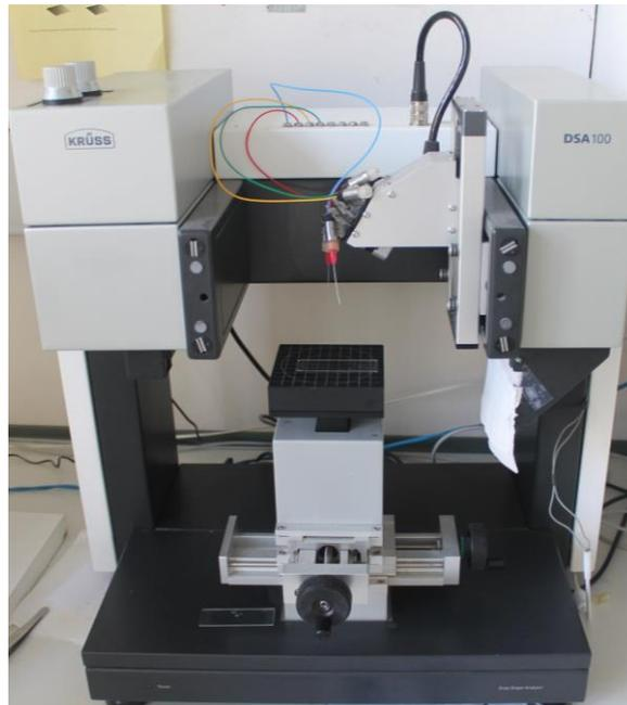
**Slika 11: Naprava za merjenje stičnega kota, Drop Shape Analysis System DSA 100 Contact Angle Meter, KRÜSS, Nemčija.**
