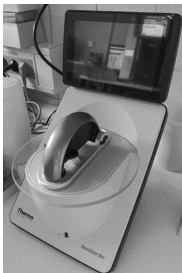
**Slika 2: Spektrofotometer NanoDropOne**
