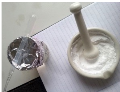
Slika 22: Princip adsorpcijske metode – vgrajevanje tekočega SMES v trdni nosilec z mešanjem s pestilom v terilnici.
