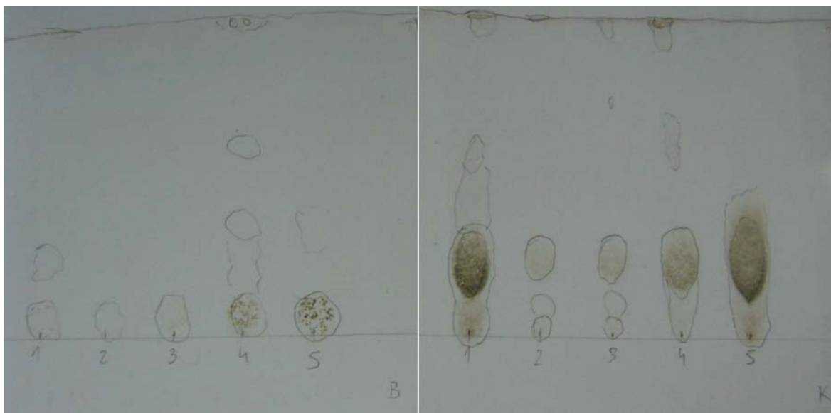
Slika 9: Fotografija razvitih TLC plošč rastlinskih vzorcev poskusa 6. Na levi strani TLC plošča razvita z MF 2, na desni strani TLC plošča razvita z MF 3.
