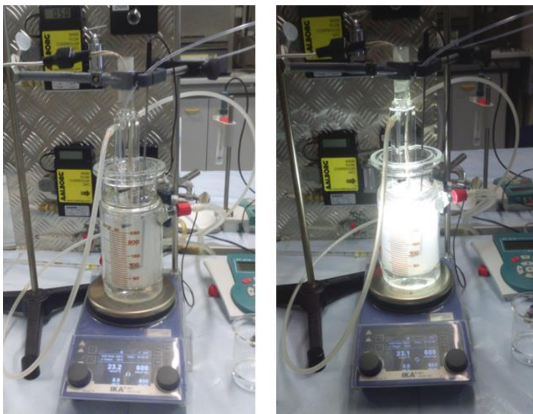
Slika 8: Reaktorski sistem za fotokatalizo pred (levo) in med (desno) poskusom
