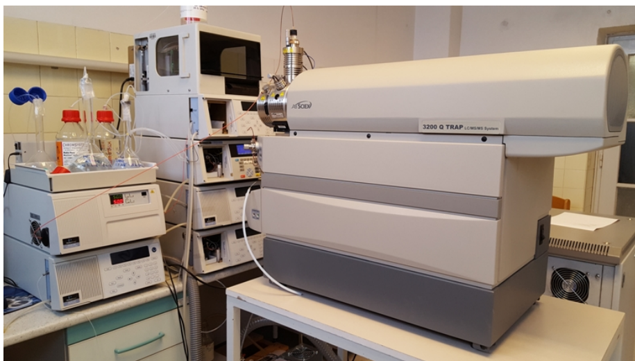
Slika 4: Sistem LC-MS/MS (fotografija posneta v presnovnem laboratoriju Službe za specialno laboratorijsko diagnostiko Pediatrične klinike)
