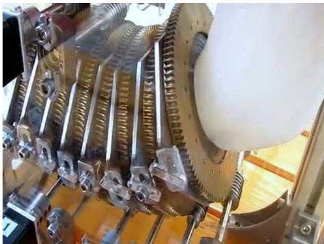
Slika 10 in 11: Prikaz zaslonk naprave za posnemanje želodčnega gibanja in mehanskih delov, potrebnih za ustvarjanje vzorcev gibanja, povzeto po (32).
