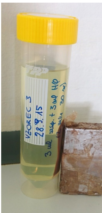
Slika 6: Ločba delno votlih superparamagnetnih nanodelcev od disperznega medija v magnetnem polju.
