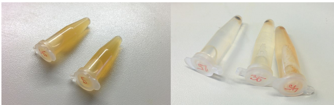
Slika 24: Disperzija delcev pred ultracentrifugiranjem (levo) in po ločbi (desno).
