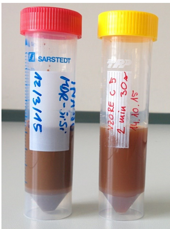
Slika 12: Osnovna disperzija superparamagnetnih nanodelcev iNANOvative™ (levo) in disperzija delcev z delno raztopljenimi magnetnimi jedri (desno).
