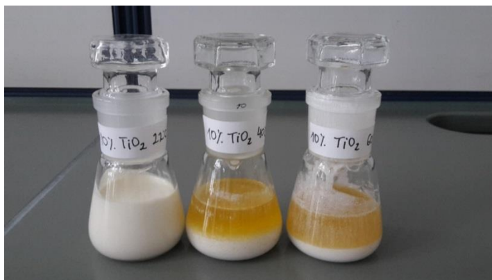
Slika 9: Primerjava vzorcev z 10% deležem TiO 2 : sobna temperatura (levo), 40 °C (na sredini) in 60 °C (desno).
