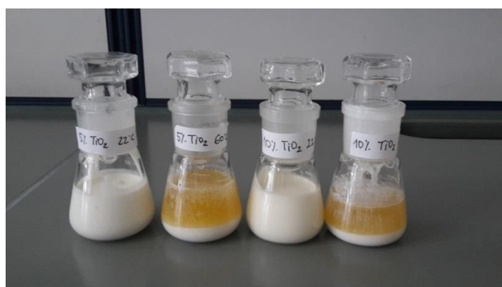
Slika 10: Primerjava vzorcev s 5% in 10% deležem TiO 2 : 5% TiO 2 na sobni temperaturi, 5% TiO 2 na 60 °C, 10% TiO 2 na sobni temperaturi, 10% TiO 2 na 60 °C (iz leve proti desni).
