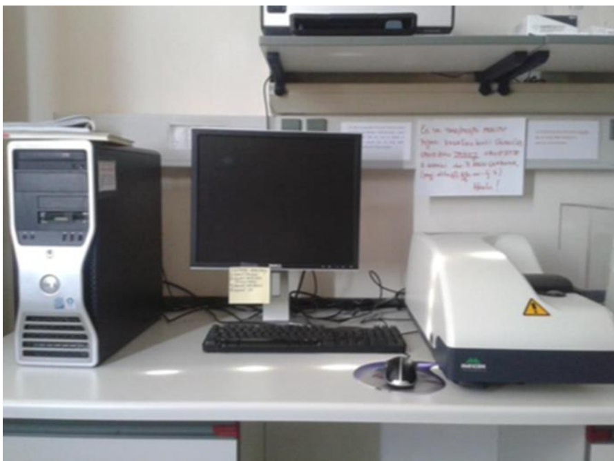
Slika 4: Zetasizer Nano ZS, aparat za merjenje velikosti kapljic (mikro)emulzij, nastalih z redčenjem SMES z vodo
