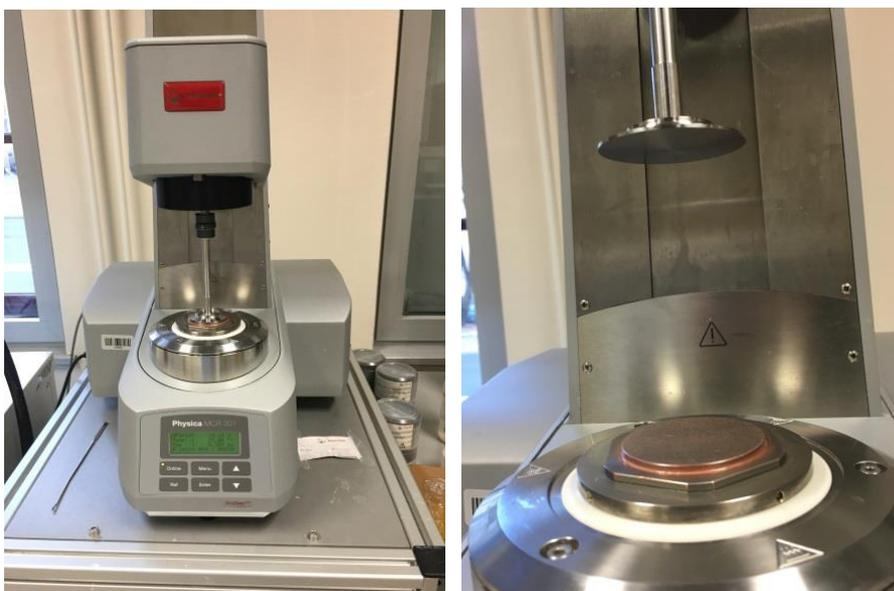
Slika 10: Reometer Anton Paar in senzorski sistem stožec-ploščica (Foto: S. Pirnat).
