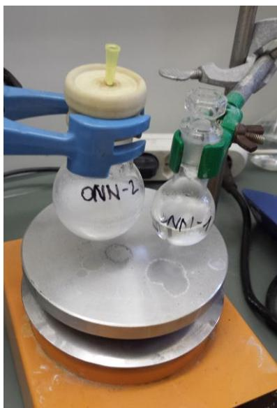
**Slika 9:** Nastavljene reakcije redukcije (bučka levo) in epoksidacije (bučka desno) davanona.
