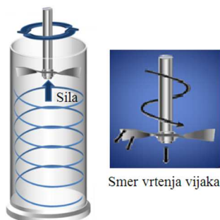
Slika 6: Prikaz potovanja vijaka v praškovnem reometru (povzeto po viru 26)
