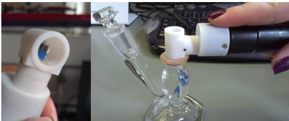
Slika 5: Zgradba sonde Tewametra (levo) in prikaz meritve TEWL (desno).
