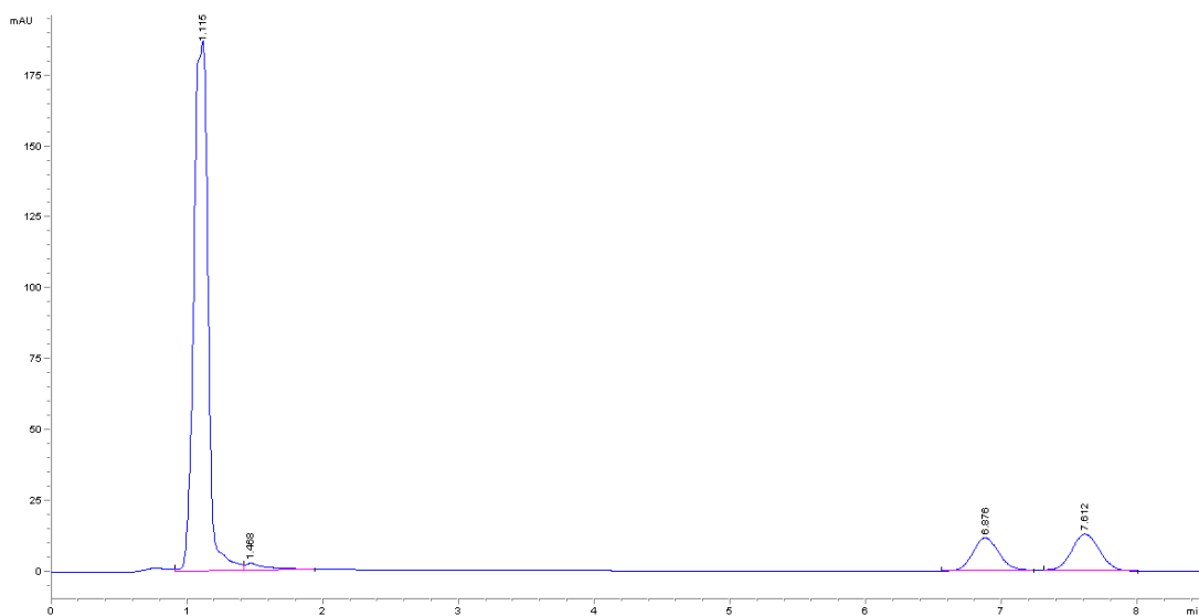
Slika 6: Kromatogram zmesi reducirane ( t_R = 12,1 min) in oksidirane oblike ( t_R = 13,7 min) CoQ 10 na koloni Synergi Hydro, C18, 250×4,6 mm.
