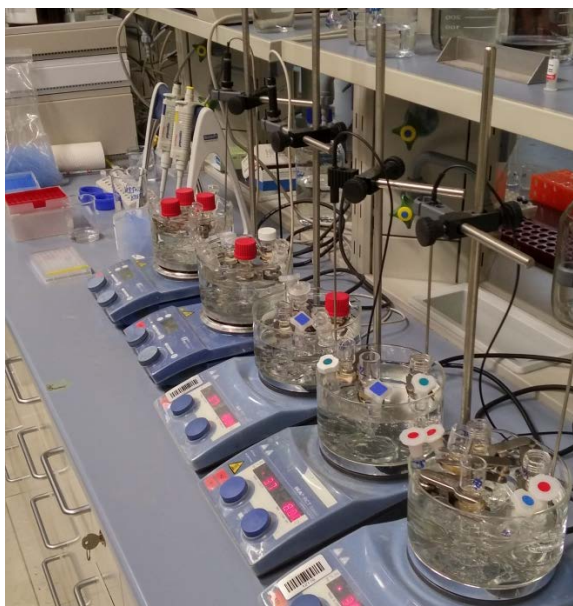
Slika 7: Franzove celice v termostahiranih magnetnih mešalih (vir: lasten arhiv)
