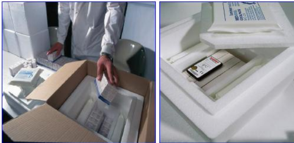
Slika 6: Primer pasivnega sistema transportnega zabojnika, izoliranega s polistirenom. Na desni polovici slike je zabojnik opremljen tudi z merilcem temperature (50)
