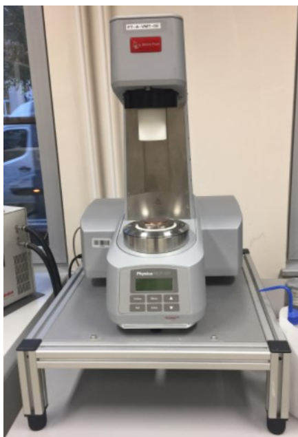
Slika 9: Viskoizimeter Anton Paar Physica MCR 301 (Graz, Avstrija)
