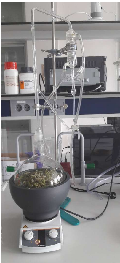
Slika 2: Pridobivanje eteričnega olja rmana s Clevengerjevo aparaturo (postopek destilacije z vodno paro) (foto: K. Schoss)
