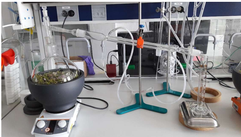
Slika 8: Pridobivanje hidrolata (foto: K. Schoss)
