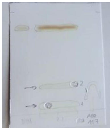
Slika 28: TLC ploščica z nanešenim DPPH, koncentrirano reakcijsko zmesjo in spojino 5 , ter struktura novonastale spojine.
