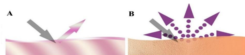
Slika 2: Odbijanje svetlobe s površine kože brez in z nanešenimi mikrodenci. 2A - zrcalno odbita svetloba s površine, na kateri ni nanesenih matirajočih mikrodenc 2B - difuzno odbita svetloba s površine, na kateri so naneseni matirajoči mikrodenci (siva puščica-vpadla svetloba; vijoličaste puščice-difuzno odbita svetloba) (prirejeno po 22).
