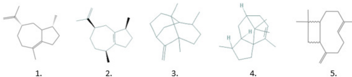
Slika 20: Kemijske strukture: 1. \alpha -bulnezen, 2. \alpha -gvajen, 3. sejšelen, 4. \alpha -pačulen, 5. (E)-kariofilen.
