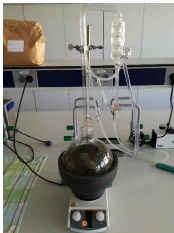
Slika 6: Aparatura za destilacijo EO (Foto: Š. Koren).
