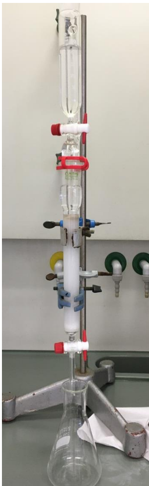
Slika 6: Aparatura za kolonsko kromatografijo.
