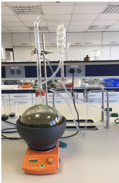
Slika 4: Clevengerjeva aparatura za destilacijo z vodno paro.
