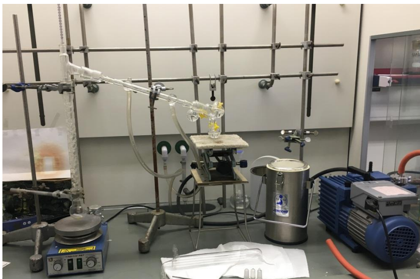
Slika 5: Postavljena aparatura za frakcionirno vakuumsko destilacijo.
