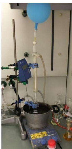
Slika 7: Aparatura za reakcijo sinteze metil 2-(2-izopropil-5-metilfenoksi)acetata.
