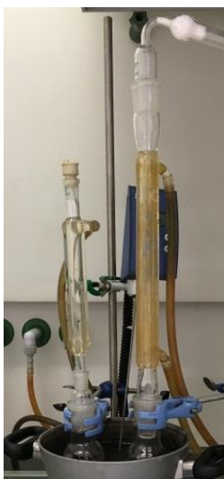
Slika 9: Aparatura za reakcijo sinteze 2-izopropil-5-metilcikloheksil 3,5-dinitrobenzoata.
