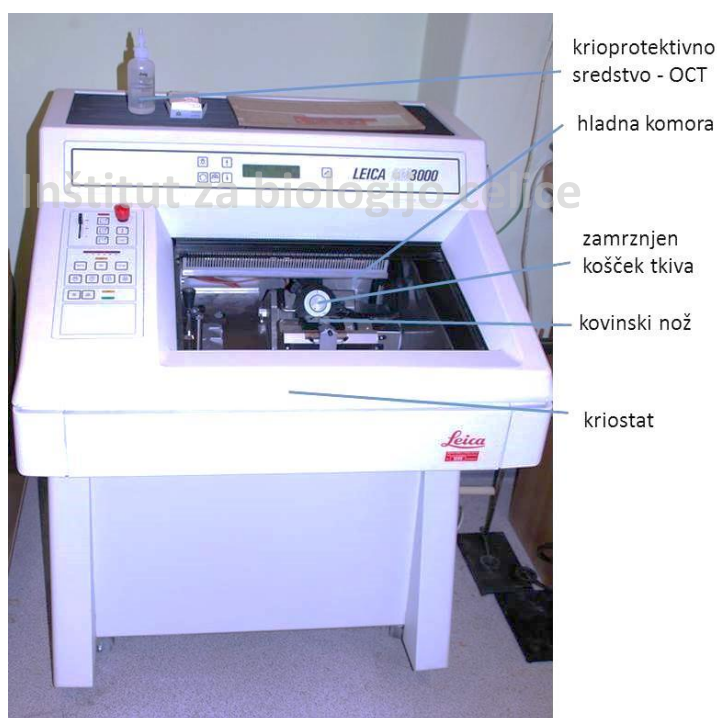
Slika 19: Kriostat je naprava za rezanje zamrznjenih rezin.
