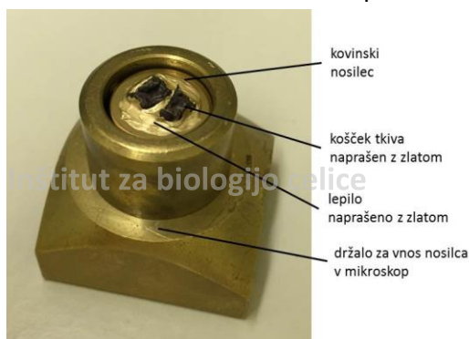
Slika 23: Posušen in z zlatom naprašen košček tkiva je prilepljen na kovinski nosilec, ki je vpeta v držalo za vnos v vrstični elektronski mikroskop.
