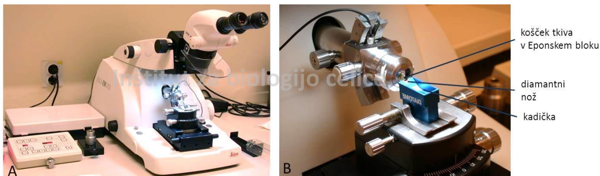
Slika 21: A) Ultramikrotom je naprava za rezanje poltankih in ultratankih rezin. B) Diamantni nož in Epski blok s koščkom tkiva sta vpeta v ultramikrotom.
